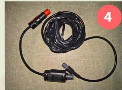
Sunware FOX-062 mit Verlängerungskabel verbunden um es an das Solarpanel direkt anzuschließen.
