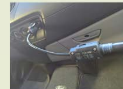
Laden: Über den Zigarettenanzünder vorn oder hinten oder als Option über den Anschluss unter dem Fahrersitz über CTEK Anschlussstecker als Option.
