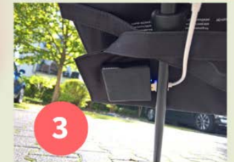
Befestigung des Solarpanels am Stativ über vorhandene Klettverschlüsse der Tasche. Output-Box ist vor dem Regen geschützt.
